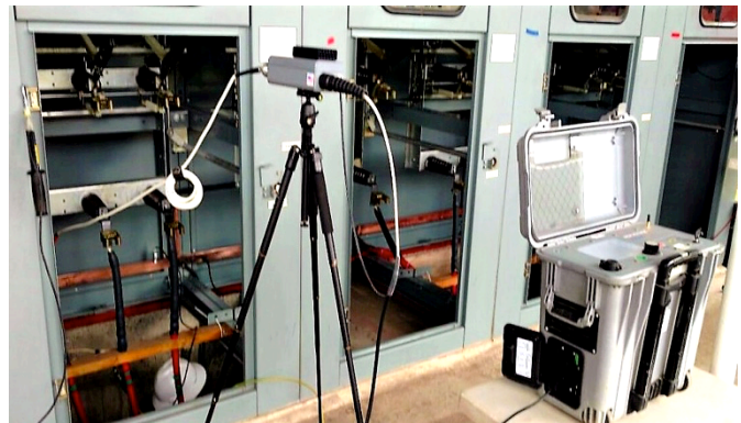
HVI VLF-34E & TD 65E testing 15kV cable
